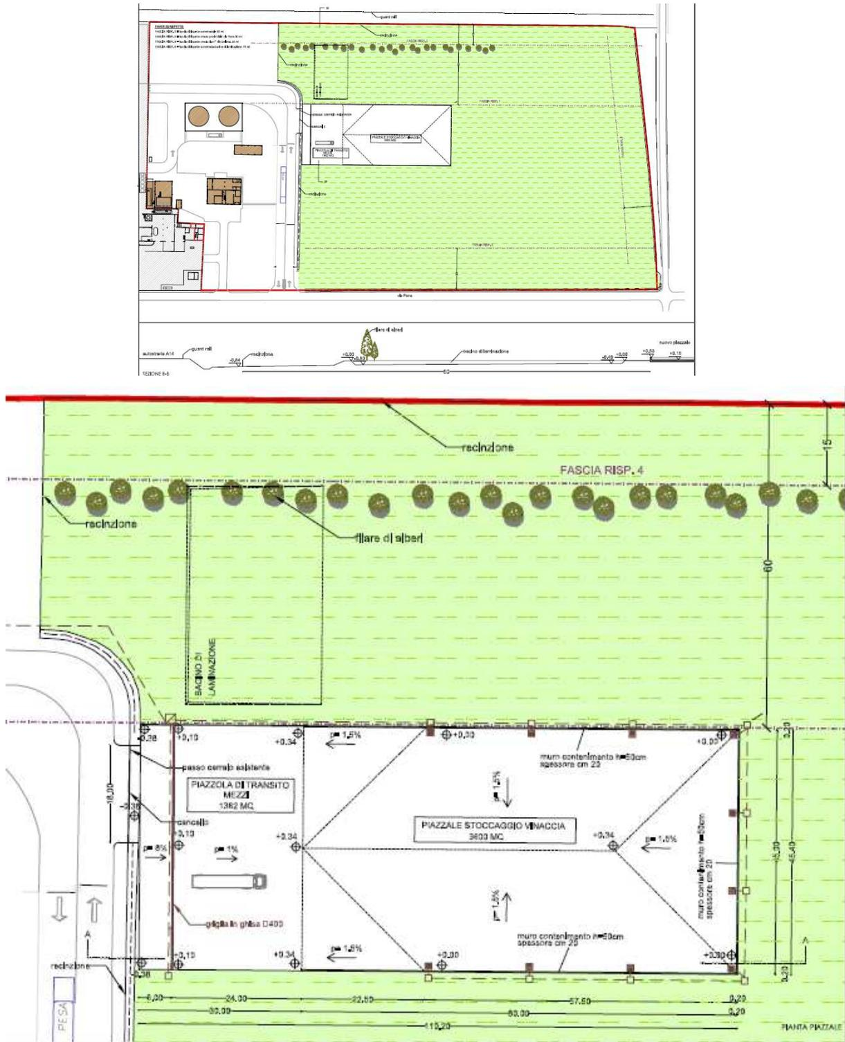
Figura 6: planimetria generale di progetto e dettaglio planimetrico relativo al piazzale
